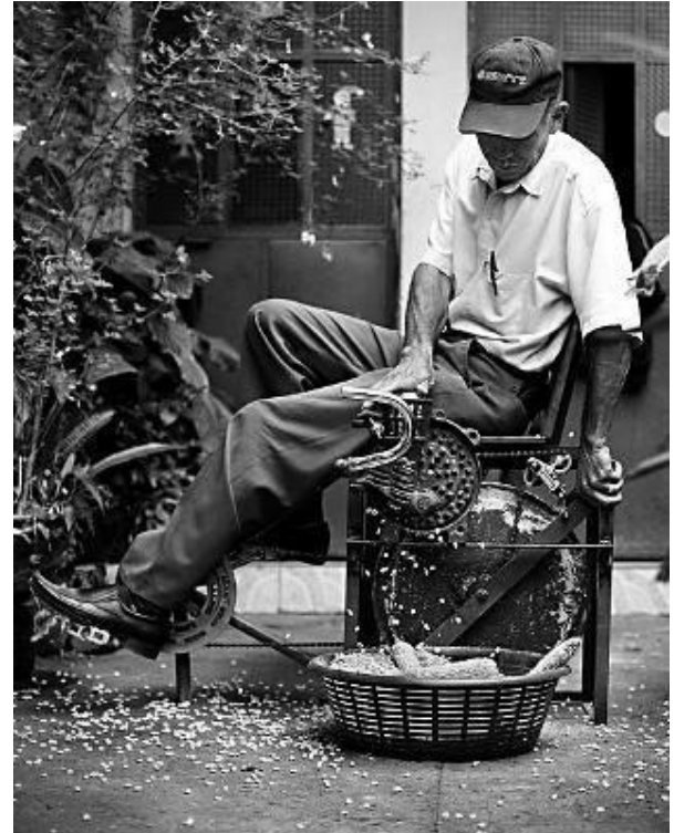
Bicidesgranadora (mulino/trebbiatrice mais), progettata e realizzata da Maya Pedal. La funzione mulino può macinare qualsiasi cereale. La trebbiatrice sgrana facilmente 12-15 quintali al giorno e richiede l'intervento di una sola persona
