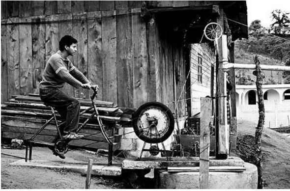
Bicibomba (pompa dell'acqua a pedali), una delle bicimachinas progettate e realizzate dall'associazione Maya Pedal, in grado di estrarre 30 litri al minuto da pozzi profondi 30 metri
